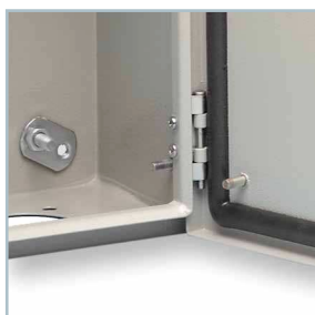
Der Boden des Unterteils ist mit geschweißten M8-Schrauben ausgestattet, die Tür mit M6-Schrauben. An einer Seite befindet sich eine M6-Erdungsschraube.
